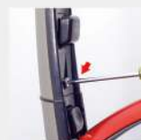
3、用螺絲起子鎖緊螺絲
