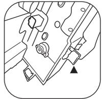
3. 打开污水箱扣, 倒除污水, 并清洗
