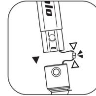
3. 接合电线接头并将下接管连接弯管
