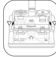
5. 打开左右水箱扣可提起水箱装水
