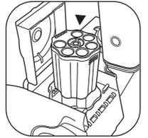
4. 打开电池盖放入电池后盖上盖子
