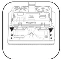
3. 组装回去时, 注意需先扣上两侧凹槽
