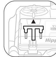
1. 满水浮标吸起时请将污水倒除 (吸力声音会变小)
