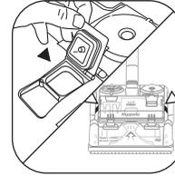
6. 开启清水箱盖加入清水至满水线, 放回水箱下压到底并扣紧
