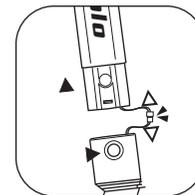
2. 按压接管扣卸除接管与转弯管并分离电线接头
