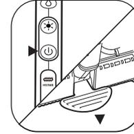
7. 按下电源钮踩下踏板前推机身洗刷, 后拉机身吸干地板
