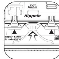
1. 扳起左右吸水盖扣清洗刮条卡垢
