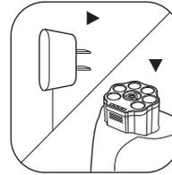
1. 将电池放入充电座并接上电源 (充电器)
